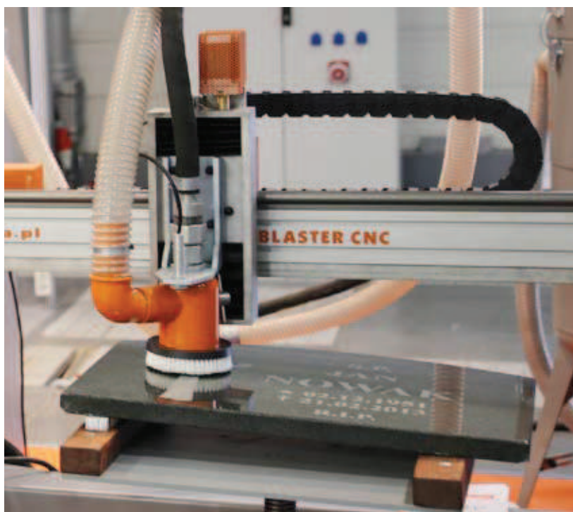
Autoblaster CNC pozwala na piaskowanie niewypoziomowanych powierzchni.
